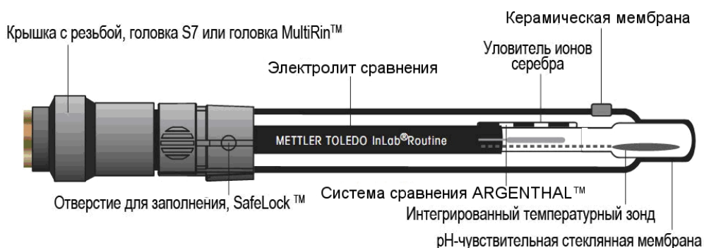
Рис. 11. Стандартный комбинированный рН-электрод со внутренним рН-сенсором и внешним элементом сравнения.
