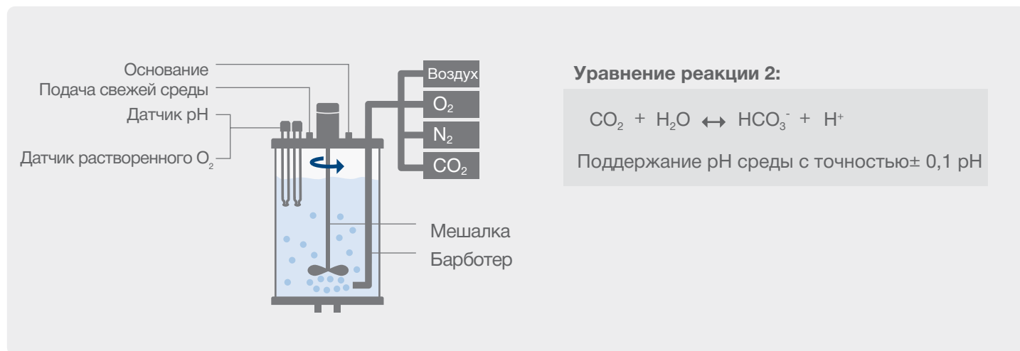
Рис. 4: Биореактор с барботажной системой для нескольких газов.
