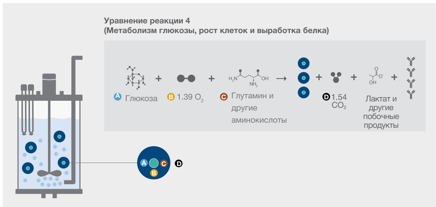
Рис. 6: Упрощенная схема глюкозно-лактатного метаболизма, роста клеток и выработки белка.
