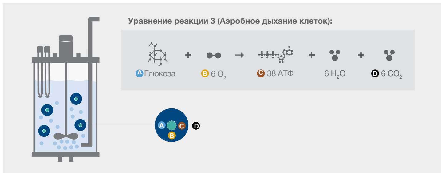
Рис. 5: Упрощенная схема аэробного дыхания клеток.
