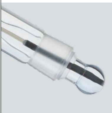
При использовании системы сравнения ARGENTHAL™ большинство pH-электродов МЕТТЛЕР ТОЛЕДО заполняется раствором 3 моль/л KCl. Это исключает опасность загрязнения проб ионами серебра. Для анализа неводных образцов или растворов с низкой ионной силой применяются специальные солевые мостики. Следите за тем, чтобы электрод всегда был заполнен свежим электролитом.
