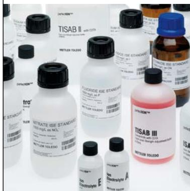
В ходе любых аналитических процедур с использованием ИСЭ ко всем пробам и стандартам перед измерением или калибровкой необходимо добавлять определенное количество раствора для корректировки ионной силы. Это обеспечивает одинаковую и постоянную ионную силу проб и стандартов. В руководстве к каждому ИСЭ даны указания в отношении типа и количества корректора ионной силы.
