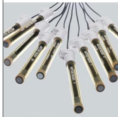
Важно, чтобы все электроды сравнения ИСЭ были заполнены рекомендованным электролитом. При правильном выборе электролита снижается разность потенциалов на мембране и обеспечивается оптимальная температура и время отклика. Для достижения наилучших рабочих характеристик необходимо регулярно доливать и заменять электролит. Дополнительная информация - в руководстве по применению электрода.
