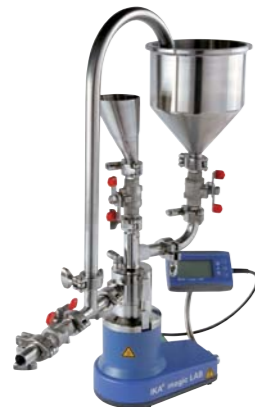
magic LAB® с модулем CMS и принадлежностями > для введения в жидкость порошков или гранул в режиме рециркуляции
