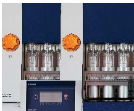
Работа с двумя блоками экстракции в растворитель из одного блока управления для уменьшения ручной обработки.
