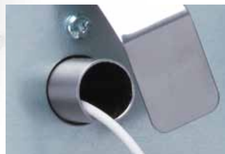
Выделенный порт доступа (диаметром 18 мм) позволяет устанавливать автономные датчики
