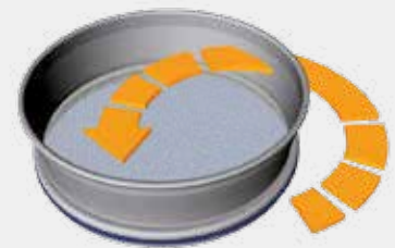
Принцип горизонтального рассева
