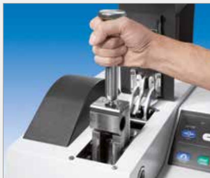
Мелющая щёка легко снимается без использования инструментов
