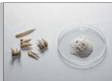
Мельница и Виброгрохот в одном приборе Зубы до и после измельчения с помощью FRITSCH PULVERISETTE 0
