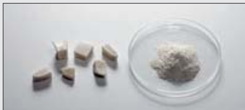
Костный материал до и после измельчения с помощью FRITSCH PULVERISETTE 0
