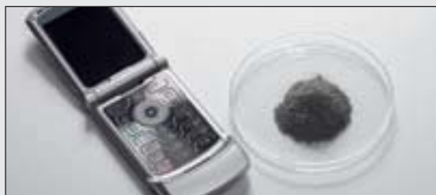
Клавиатура сотового телефона: результат измельчения после охрупчивания в условиях заморозки
