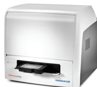
Мультимодальный планшетный ридер Thermo Scientific™ Varioskan™ LUX
