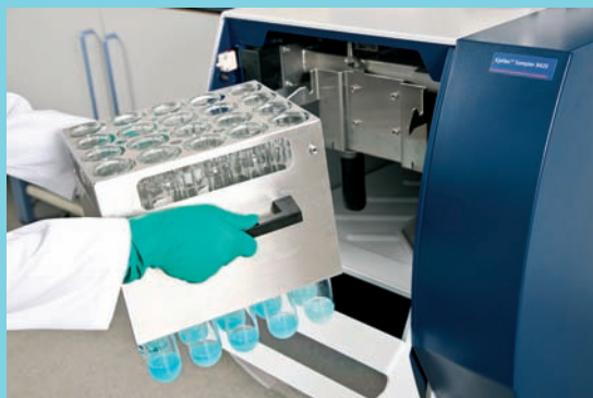
Просто загрузите ваши стойки для образцов прямо из дигесторного блока, и Kjeltex™ выполнит точный анализ без участия персонала в течение более четырех часов.
