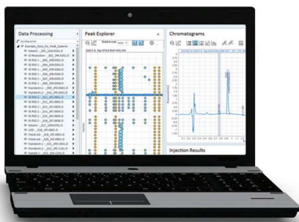
Инструмент визуализации Peak Explorer ускоряет выявление и устранение проблем. Быстрое обнаружение аномалий даже среди сотен хроматограмм и пиков.
