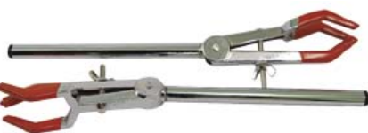
Лапка трёхпалая (для холодильников), максимальный захват – до 60 мм.
