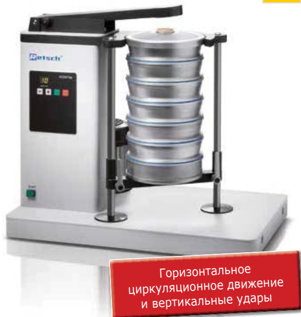
Просеивающая машина AS 200 tap с комплектом сит
