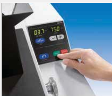
Цифровая регулировка скорости и отображение величины зазора щёк
