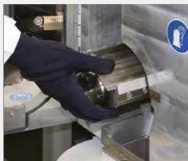
Быстроръёмный ротор для облегчения и ускорения очистки
