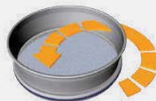
Принцип горизонтального рассева
