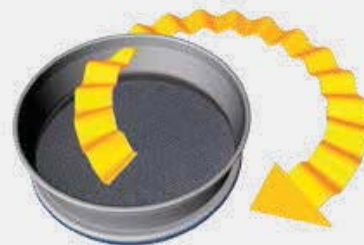
Принцип рассева с вертикальными ударами
